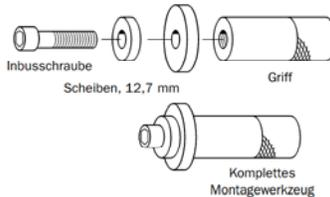
Mit diesen Sätzen verfügen Sie immer über die richtige Werkzeuggröße zur Montage jeglicher Dichtungen, Lager oder Buchsen. Einfach die geeignete Scheibe auswählen, den Handgriff mit Inbusschrauben einsetzen und das Werkzeug mit einem Hammer eintreiben.
