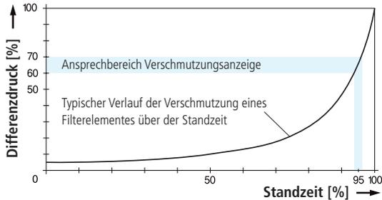
Mit zunehmender Einsatzdauer nimmt die Verschmutzung eines Filterelementes und somit der Druckverlust zu. Der hierdurch entstehende Differenzdruck  $\Delta p$  wird von der Verschmutzungsanzeige überwacht und bei Erreichen eines voreingestellten Wertes ein elektrisches und/oder optisches Signal gegeben.
