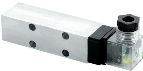
**Funktion:** Der eingebaute Reedschalter schaltet um, sobald der eingestellte Differenzdruck überschritten wird. Bei Temperaturen unter 32°C öffnet ein Temperaturschalter und blendet somit das Signal des Differenzdruckschalters aus. Die transparente Gerätesteckdose mit 2 Leuchtdioden ermöglicht zusätzlich eine optische Anzeige der Filterverschmutzung (Beschreibung der Funktion s.a. DG 041).
