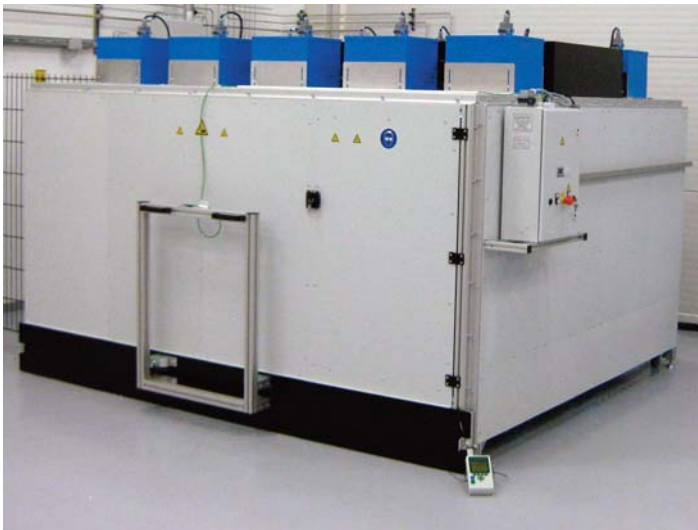
Bestrahlungskammer 2,2 m x 2,6 m
